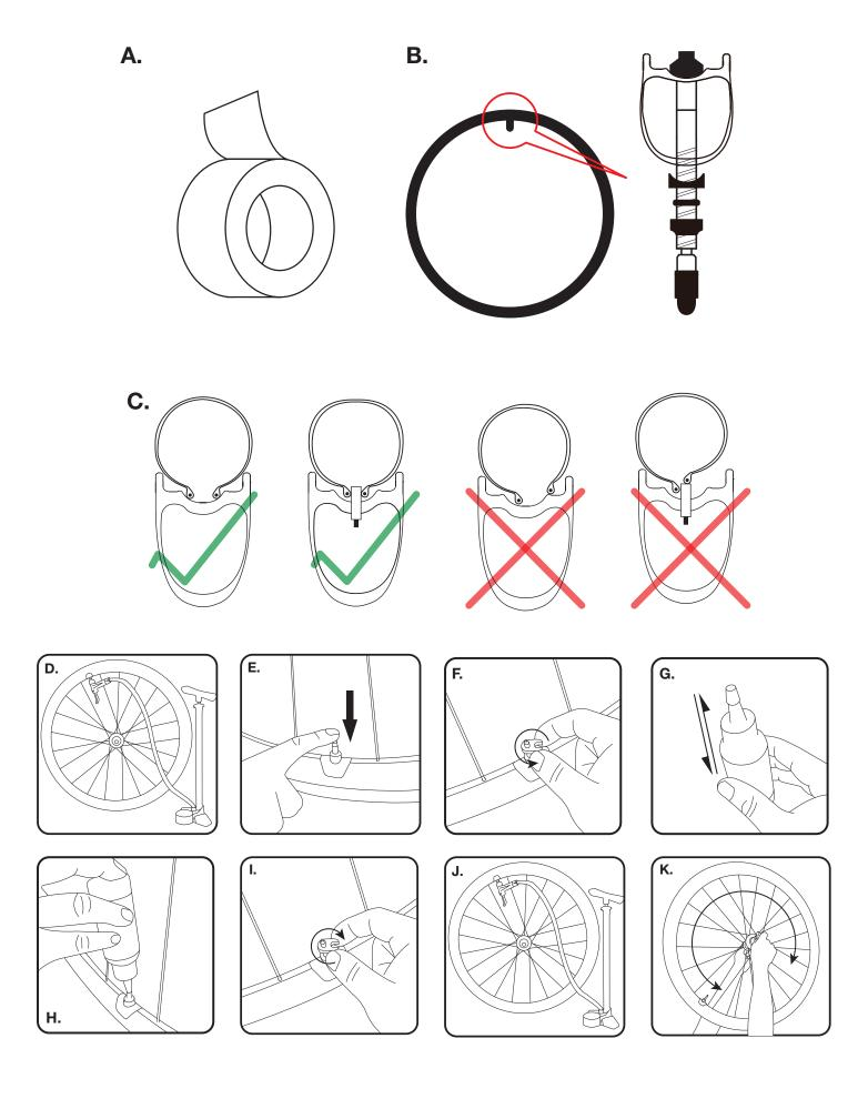
Die schlauchlosen Reifen von Giant verwenden zur Verbesserung der Luftdichtigkeit der Reifen eine Beschichtung an der Innenseite der Karkasse. Da diese Beschichtung durch Reifenheber beschädigt werden kann, montieren oder demontieren Sie den Reifen ohne Reifenheber oder mit Hilfe des speziell entwickelten Giant-Reifenhebers für schlauchlose Reifen.
